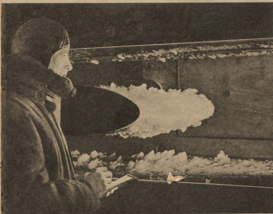
Modelo del perfil de un plano en el túnel aerodinámico de frío en el laboratorio experimental aerodinámico de Gottinga. A través de un cristal pueden observarse los procesos en el interior del túnel. El perfil se ha cubierto ya de una capa de hielo en un saliente
