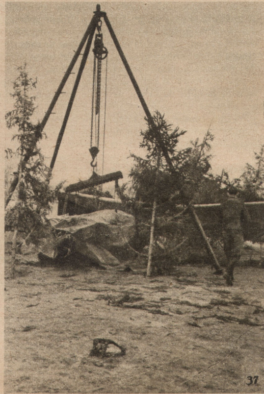
Durante las reparaciones y trabajos de preparación todo el mundo tiene trabajo. En la foto de la derecha, abajo se está separando el motor del aparato mediante una grúa
