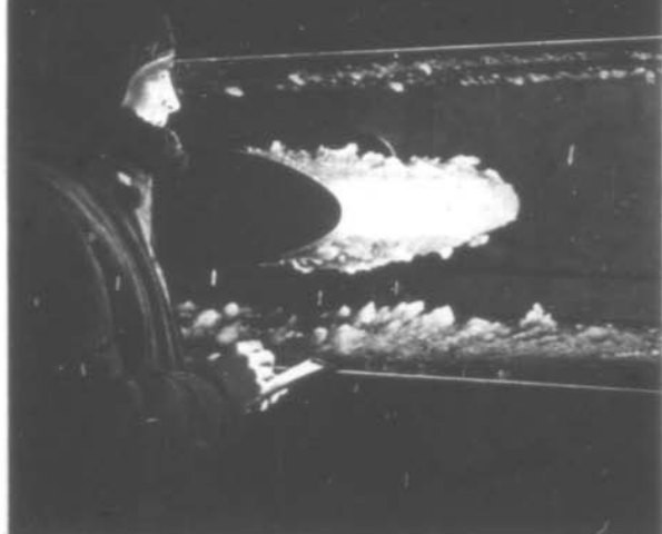
Modell eines Tragflächenprofils im Kältewindkanal der Aerodynamischen Versuchsanstalt Göttingen. Durch eine Glaschleibe können die Vorgänge im Innern des Kanals beobachtet werden. Das Profil ist herein an seiner Nase mit einer kräftigen Eischleife überzogen.
